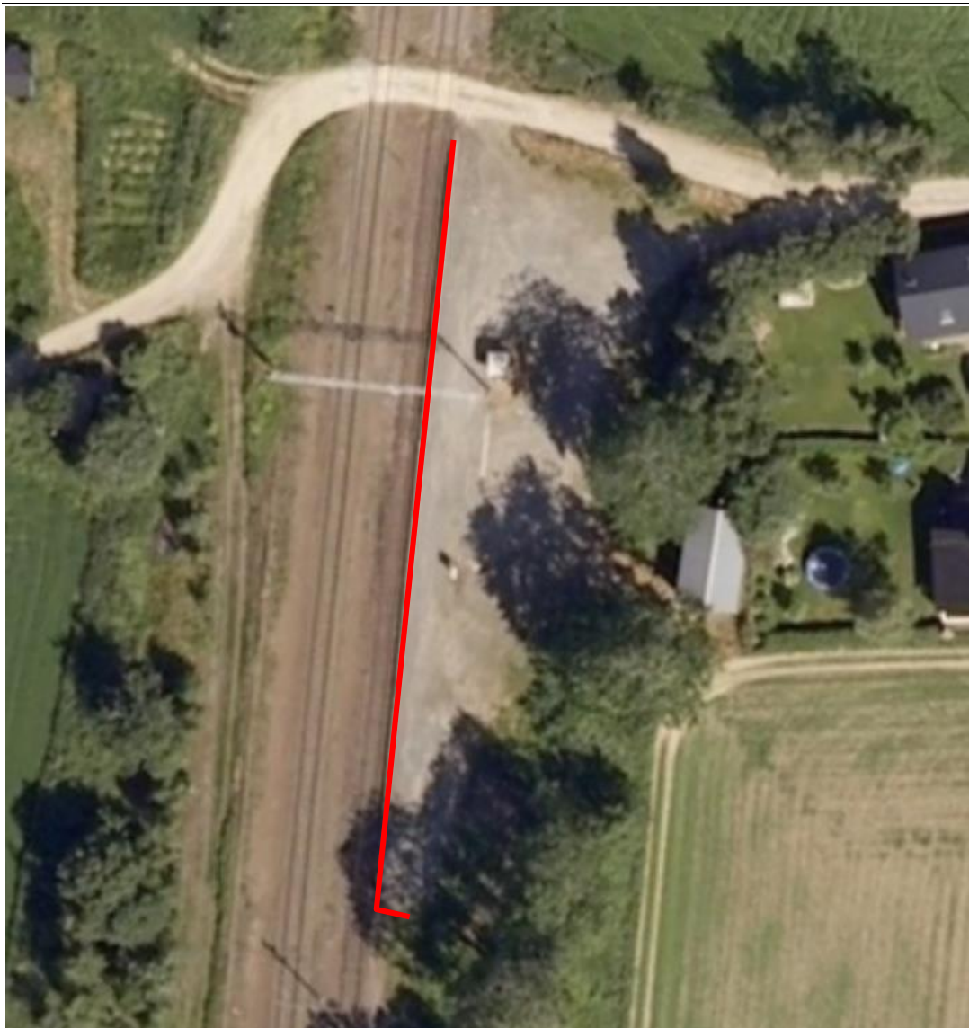
Figur 1: Eksempel på registrering av Jernbaneplattformkant (rød strek).
